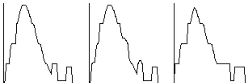
Figure 1.9 Ouverture, fermeture et l'ouverture de l'ouverture sur le même exemple.
